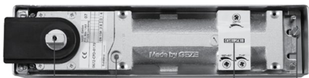
Akselapp utskiftbar fra 5 - 50mm Justerbar lukkekraft fra EN 3 - 6 Justerbar lukkehastighet, endeslag og hold-åpen/lukkeforsinkelse Enkel innfesting og høydejustering
